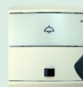
IR ontvanger en IR zender De IR zender heeft 8 programmatoetsen en een "shift toets", in andere woorden, een afstandsbediening kan 16 functies starten en stoppen
